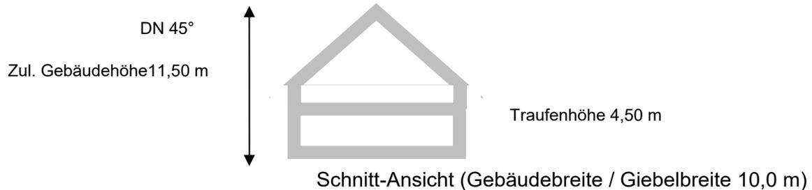
Bei einer steilen Dachneigung von 45° muss das zweite Vollgeschoss zwangsläufig als Dachgeschoss ausgebildet werden, um die max. zugelassene Gebäudehöhe nicht zu überschreiten. Daraus resultiert eine Traufenhöhe von max. 4,50 m.
