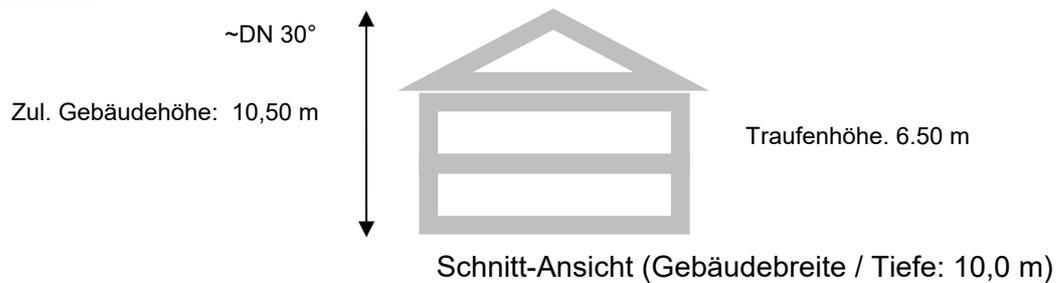
Bei einer Dachneigung von ca. 30° sind in der Regel zwei klassische Vollgeschosse möglich und ein Dachgeschoss im Nicht-Vollgeschoss-Maßstab. Die max. zulässige Gebäudehöhe darf 10,50 m nicht zu überschreiten. Daraus resultiert eine Traufenhöhe von max. ca. 6,50 m.
